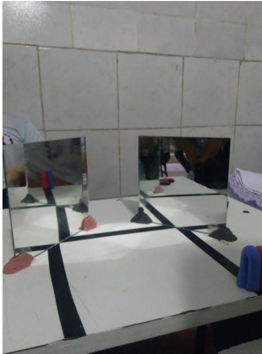
Figura 24. Espelhos posicionados para a inversão da imagem. Fonte: própria
