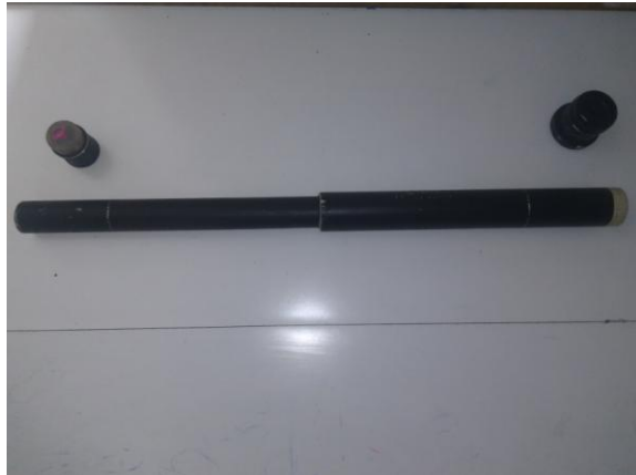
Figura 13. Após revestimento com as fitas colocamos o cano menor dentro do cano maior. Fonte: Própria
