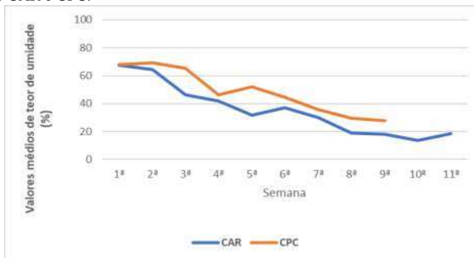
Figura 8 - Valores médios da variação temporal do Teor de Umidade (%ST) nas Unidades de Tratamento CAR e CPC.
