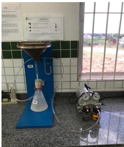
Figura 5 – Ensaio de determinação da retenção de água
