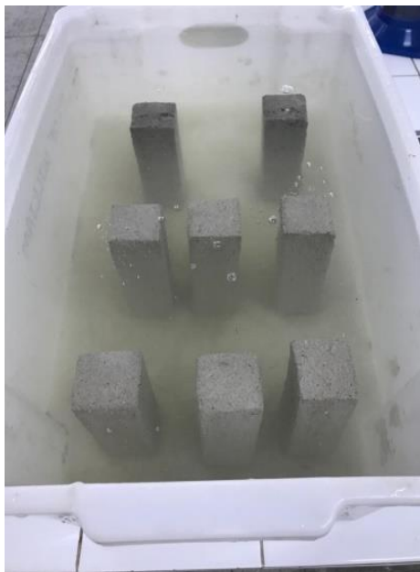
Figura 8 – Determinação do coeficiente de capilaridade
