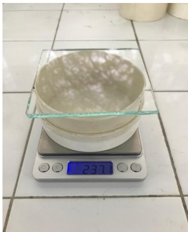
Figura 6 – Ensaio de densidade de massa no estado fresco
