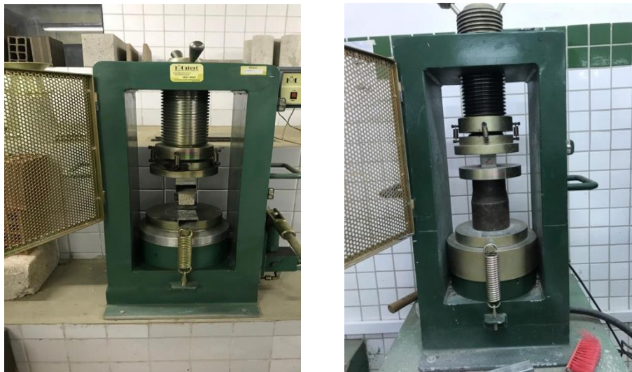
Figura 4 – Ensaio de resistência à compressão e tração na flexão
