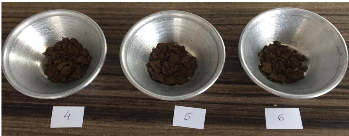
Figura 15 - Amostra de Lodo de ETA da Cidade de Patos/PB Desidratada Artificialmente Através de Estufa.
