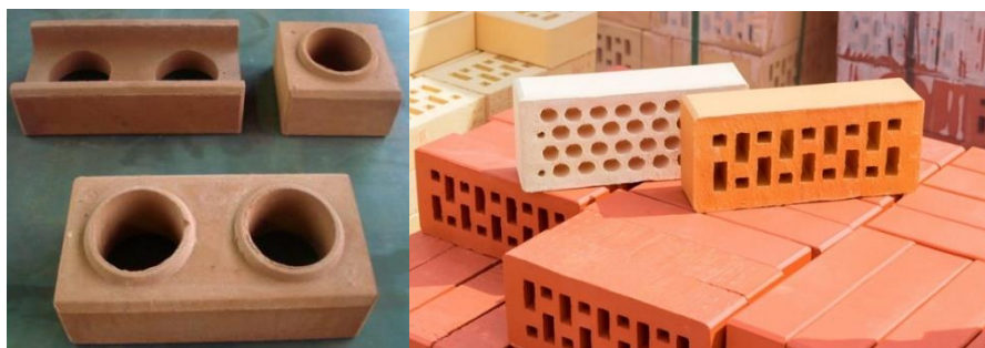
Figura 03 - Tijolo Ecológico (Solo - Cimento).
