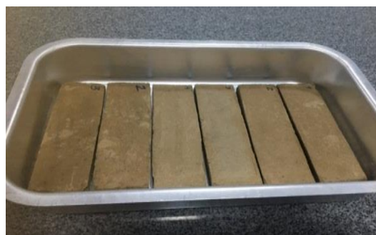
Figura 20: Compósitos cerâmicos secos.
