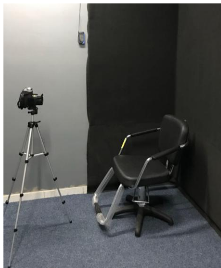
Figura 4. Paredes de fundo da sala termográfica, revestidas com isopor, papel alumínio e E.V.A. na cor preta, formando uma barreira isolante
