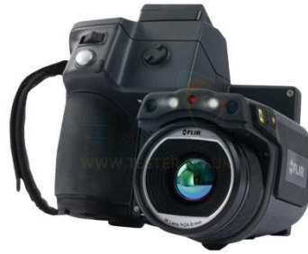
Figura 2. Câmera termográfica infravermelha FLIR modelo T650sc Infrared .
