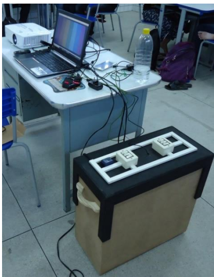
Figura 36: Câmara de luz conectada ao computador que transmite as imagens ao data show.
