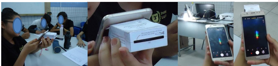
Figura 34: Aluna observando o espectro de emissão da luz fluorescente no display do seu smartphone acoplado ao espectroscópio.
