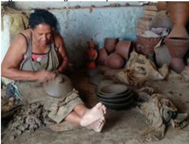
Figura 2: Modelagem da “loiça” com o uso de cabaça, realizada por uma loizeira.
