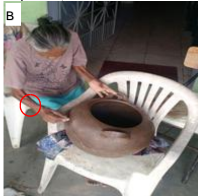
Figura 3 - B: Loizeira fazendo o alisamento da panela, com seixo.
