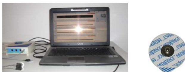
Figura 20. Eletromiógrafo portátil Miotec®, modelo Miotool e Notebook com software Miographic 2.0 e Eletrodo de superfície da marca Meditrace. Fonte: Barradas (2010) e www.miotec.com .
