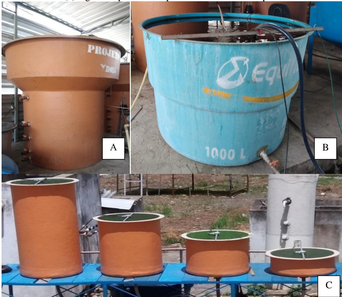
Figura 4: Foto do aparato experimental (a) reator UASB; (b) tanque de armazenamento do efluente UASB (c) lagoas de polimento operando em batelada sequencial
