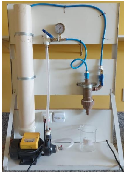
Figura 15: Sistema de medidas de fluxo de água e do efluente oleoso.
