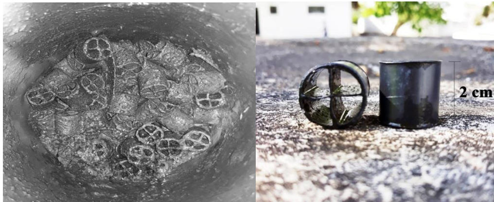
Figura 8. Fotografias dos eletrodutos de PVC utilizados como material suporte no reator anóxico.
