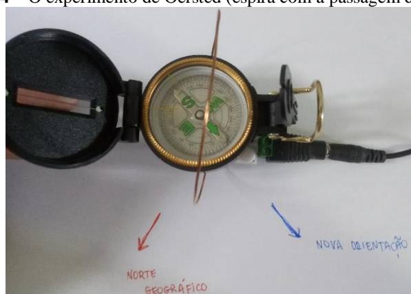
Imagem 4 – O experimento de Oersted (espira com a passagem da corrente)
