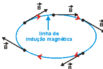
Figura 9 – Representação do vetor campo magnético \mathbf{B} e de uma linha de indução
