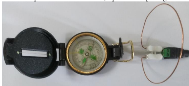
Imagem 2 – O experimento de Oersted (espira sem a passagem da corrente)
