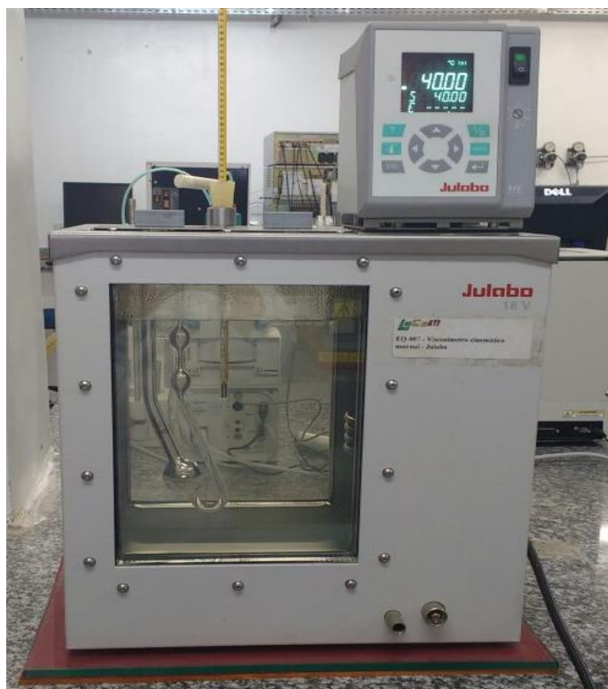
Figura 12 – Viscosímetro, modelo V18, utilizado para as análises desta pesquisa.
