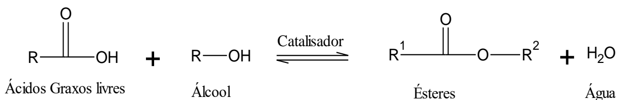
Figura 3: Reação de esterificação de ácidos graxos livres
