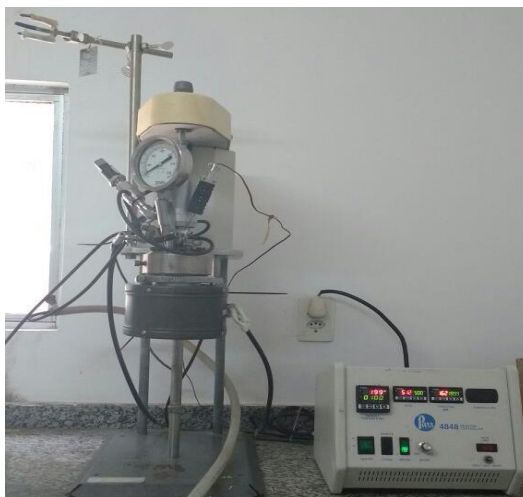
Figura 10 – Reator modelo PARR 4848 utilizado para a transesterificação/esterificação.
