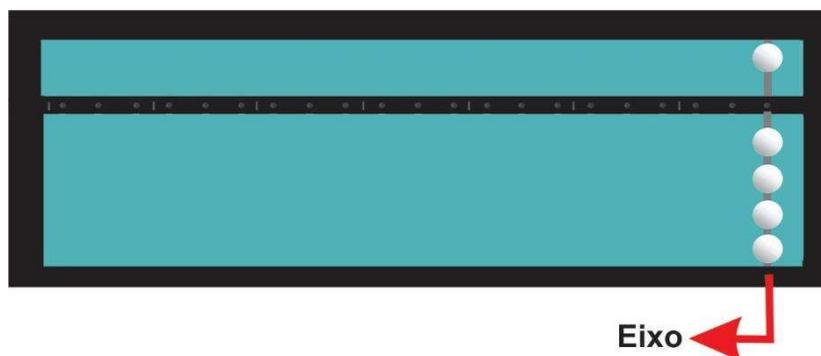
Cada eixo contém cinco contas, sendo quatro na parte inferior, em que cada conta representa o valor "um" e uma na parte superior, com valor "cinco". Cada eixo com cinco contas permite a representação dos algarismos de 0 à 9.
