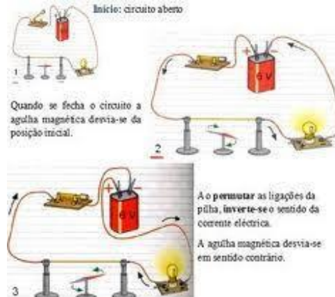
Figura 44: A passagem da corrente elétrica pelo fio desloca a agulha da bússola
