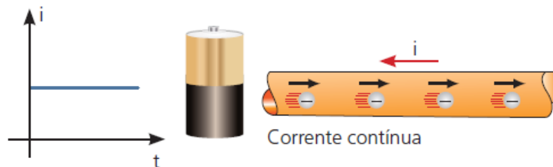
Figura 42: A corrente contínua constante tem sentido e intensidade constantes com o tempo
