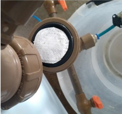
Figura C1. Configuração do Filtro FNT 1 (material não-tecido sintético).
