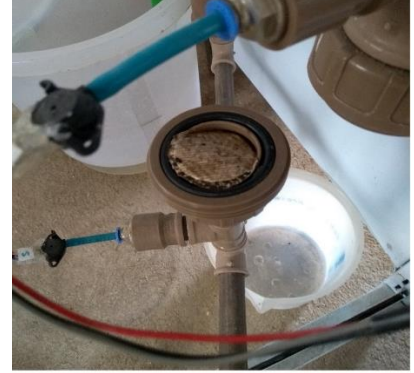
Figura C1. Configuração do Filtro FNT 1 (material não-tecido sintético).
