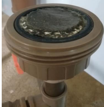
Figura C1. Configuração do Filtro FNT 1 (material não-tecido sintético).
