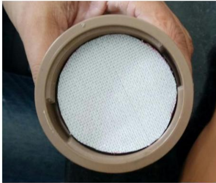
Figura 8: Interior do módulo de membrana e malha de polietileno.
