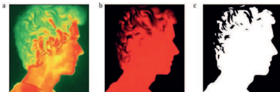
Figura 16 - a) Imagem obtida após remover intensidades de azul, b) após remover intensidades de verde, c) imagem de máscara.
