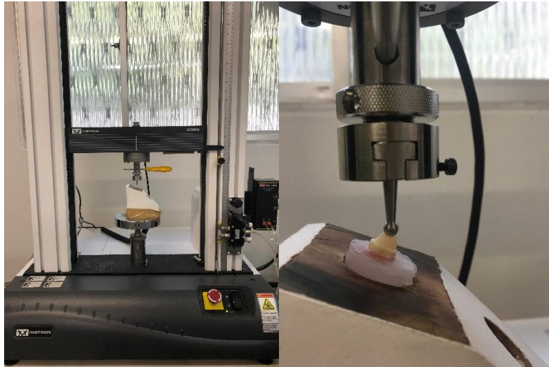
Figura 9. Indução à fratura na máquina de ensaio universal (ISTRON 3365 Machine).
