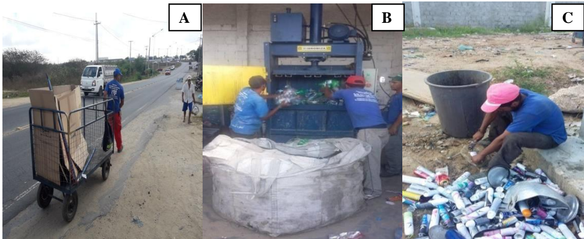
Figura 15: (A) Coleta dos resíduos sólidos recicláveis; (B) Uso da prensa para formação de fardos de resíduos sólidos recicláveis; (C) Desmanche de embalagens de desodorante.
