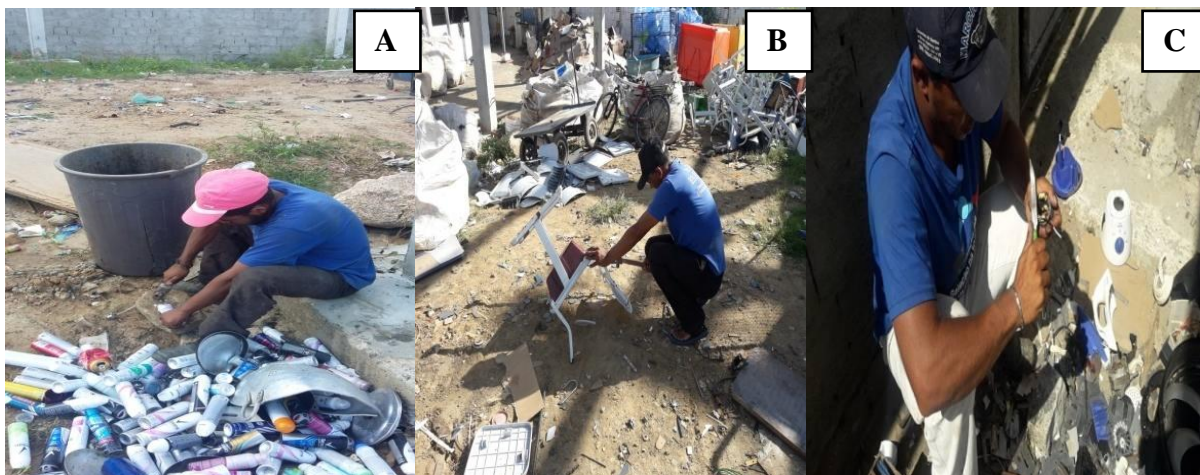
Figura12. (A) Desmanche de equipamento eletroeletrônico para retirada de fios de cobre; (B) Desmanche de cadeira para extração de ferro e plástico PVC; (C) Desmanche de embalagens de desodorante aerossol.
