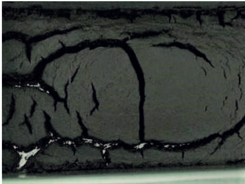
Figura 6 – Fissuras na torta de lodo apresentadas no decorrer do processo de secagem.
