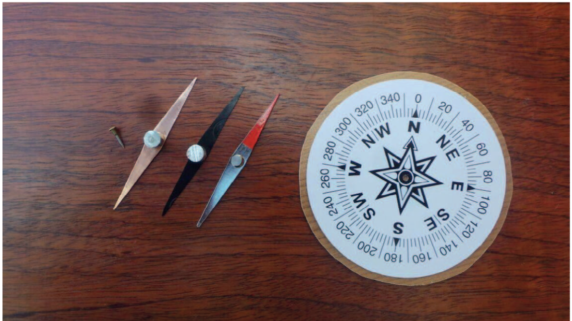
Figura 7: Bússola construída com três ponteiros de diferentes materiais
