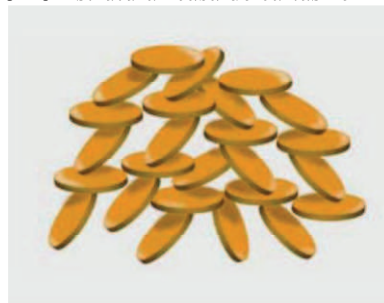
Figura 3-18 Estrutura "casa de cartas" em Laponita.
