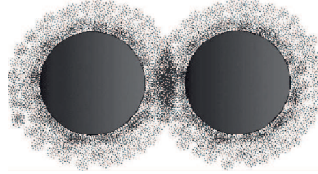
Figura 3-12 A sobreposição de camadas duplas elétricas em partículas adjacentes.
