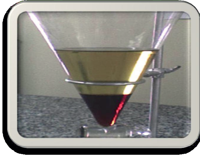
Figura 12 - Separação da glicerina após 24 horas de repouso da mistura.
