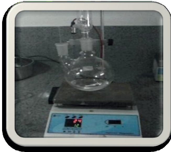
Figura 10 - Sistema de refluxo e processo de formação do metóxido de potássio.
