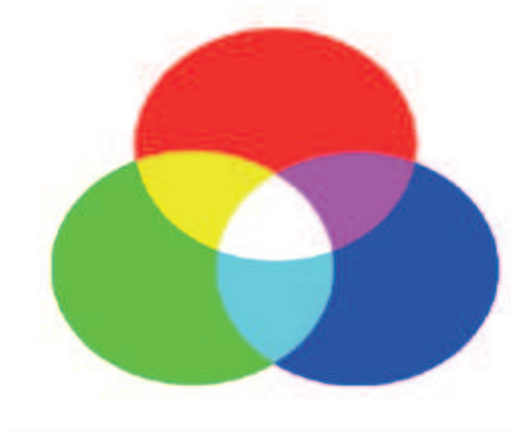
Figura 2 - Cores primárias aditivas e as cores resultantes de suas combinações R: Vermelho; G: Verde; B: Azul.
