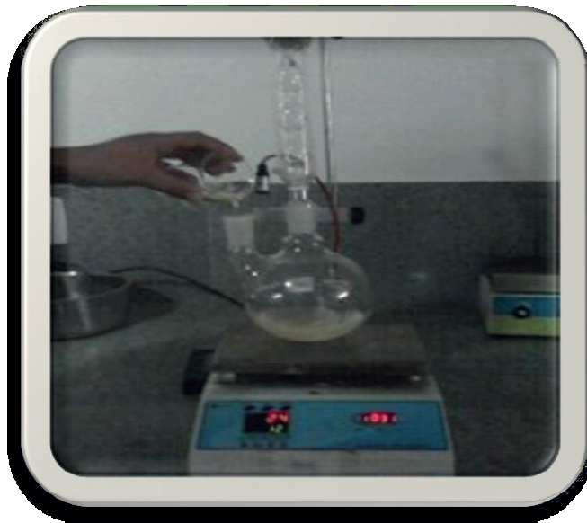
Figura 11 - Adição do óleo ao balão de duas bocas acoplado ao sistema de refluxo para reação de transesterificação.
