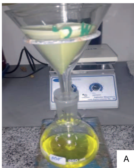
Figura 8 – Etapas de recuperação do material lipídico. (A) filtração simples; (B) amostra armazenada em balão de fundo chato (C) filtrado no evaporador rotativo (D) material lipídico concentrado.
