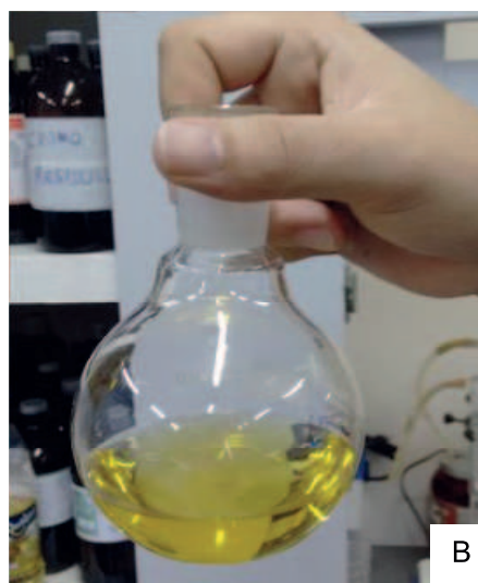
Figura 8 – Etapas de recuperação do material lipídico. (A) filtração simples; (B) amostra armazenada em balão de fundo chato (C) filtrado no evaporador rotativo (D) material lipídico concentrado.
