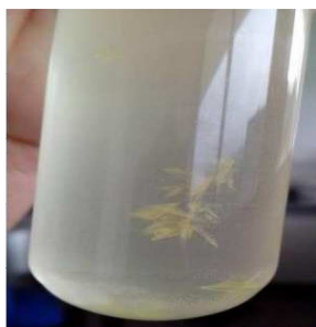
FIGURA 10 – Formação dos cristais em solução de 0,10 \text{ mol L}^{-1} do ácido lipóico em metanol a 4^\circ\text{C} .
