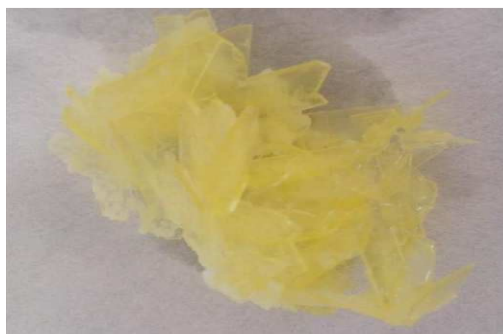
FIGURA 9 – Formação dos cristais em solução de 0,10 \text{ mol L}^{-1} do ácido lipóico em metanol a 4^{\circ}\text{C} .
