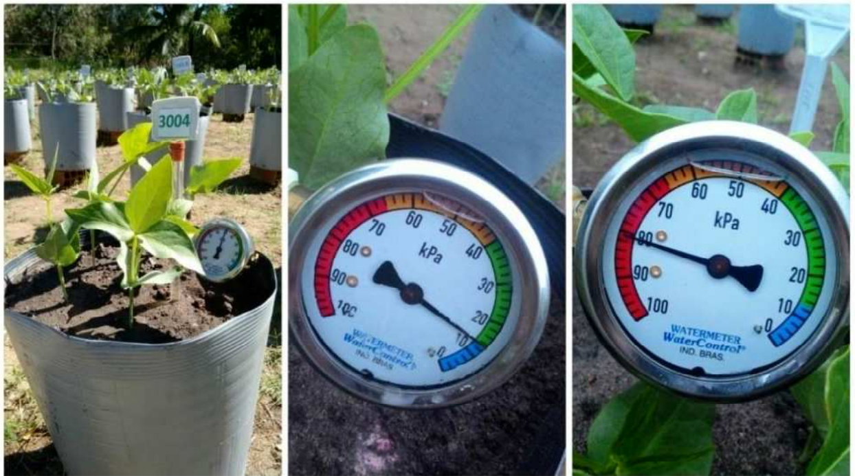
Figura 3. Tensiômetros instalados na área experimental. Campina Grande, PB, 2017.
