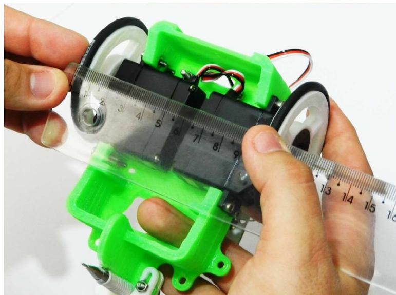
Figura 5.25: Medição da largura (eixo) da unidade robótica. Fonte: Elaborado pelo autor.
