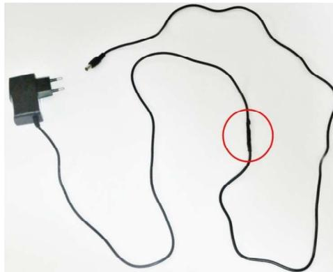
Figura 5.16: Fonte de 9V utilizada para os motores da unidade robótica. Fonte: Elaborado pelo autor.
