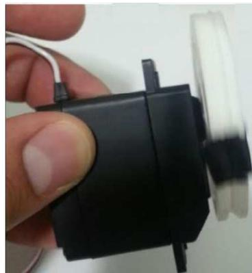
Figura 5.9: Servo motor SpringRC com a roda da unidade robótica. Fonte: Elaborado pelo autor.
