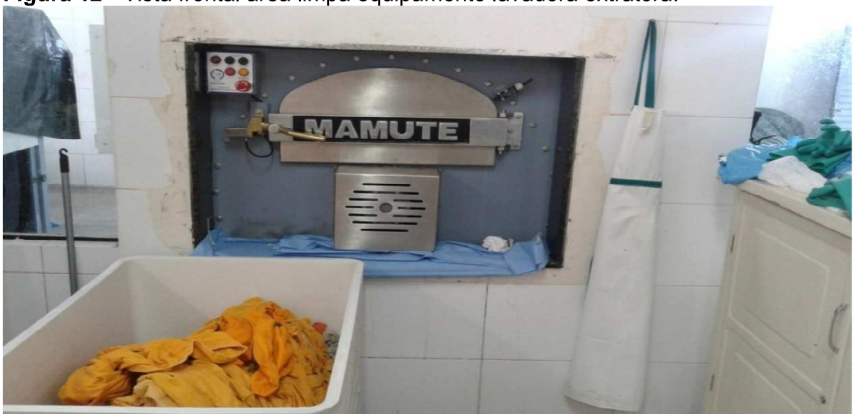
Figura 12 - Vista frontal área limpa equipamento lavadora extratora.
