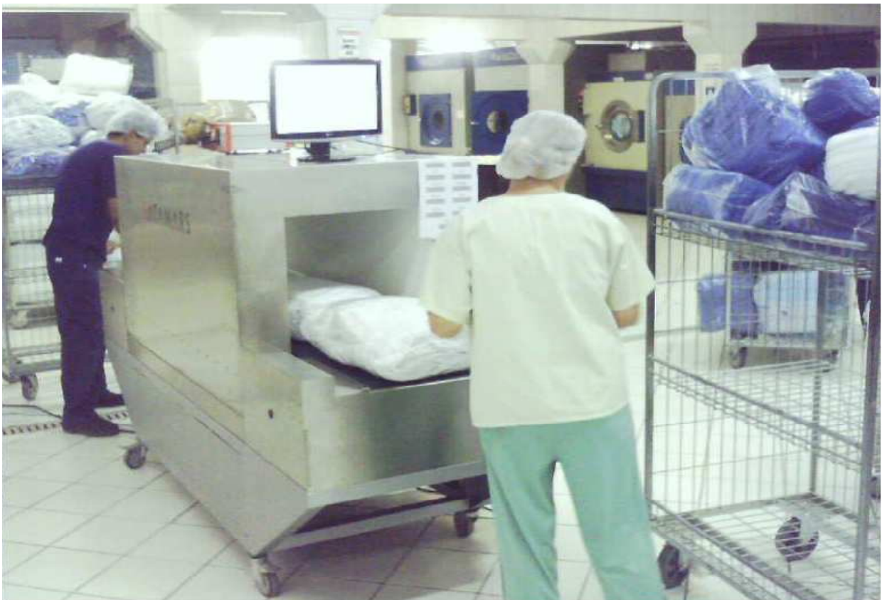
Figura 17 - Uso de antena por túnel.
