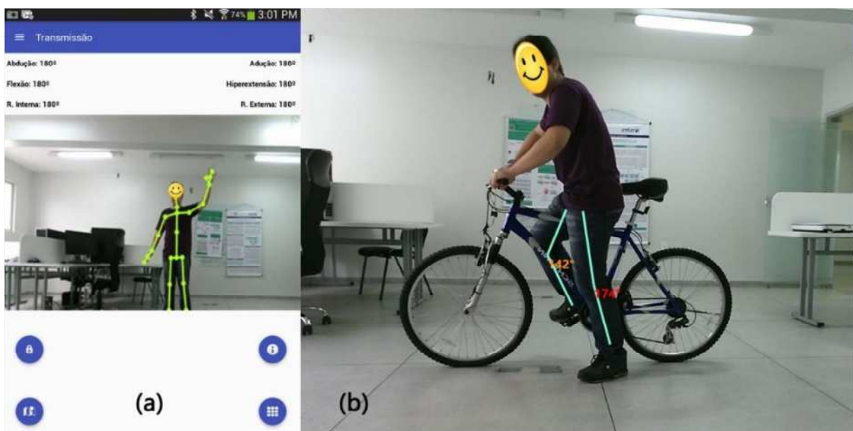
Figura 10. Outras aplicações com o uso do NuSense. a) versão mobile da aplicação de flexibilidade; b) aplicação bike fit para análise de postura em bicicletas.
