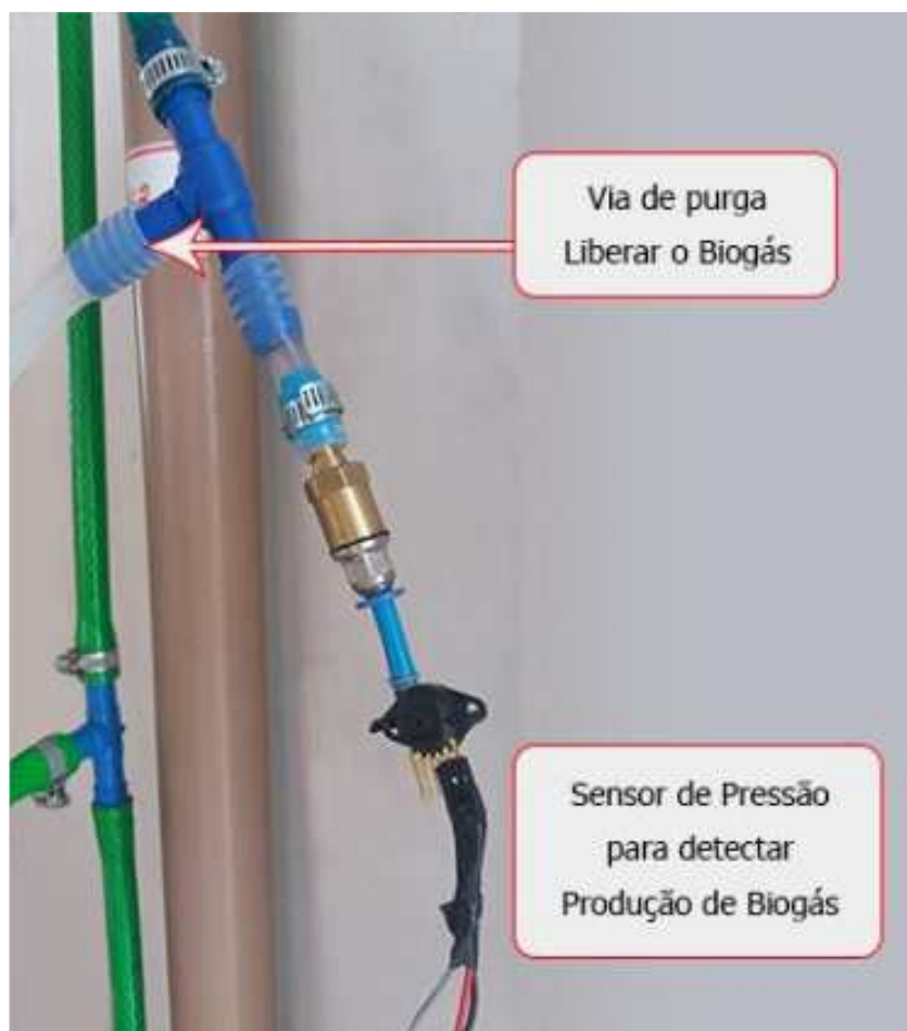
Figura 10 - Sensor de Pressão instalado no biorreator para medir a produção de Biogás
