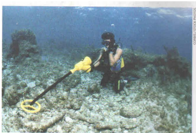
Figura 2. Detector de metais em uso subaquático Fonte: PENTEADO, 2005.
