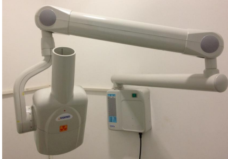
Figura 9- Aparelho convencional de raios X periapical Timex 70E. Fonte: Autor da pesquisa
