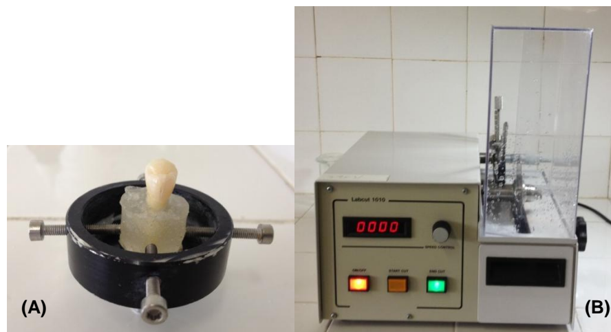
Figura 5- Bloco de dente adaptado a dispositivo da cortadeira automática (A) cortadeira automática Labcut 1010 (B). Fonte: Autor da pesquisa
