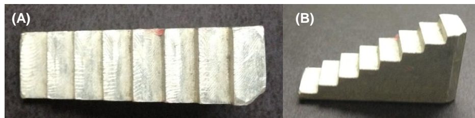
Figura 8- Penetrômetro de Alumínio vista superior (A) vista lateral (B). Fonte: Autor da pesquisa
