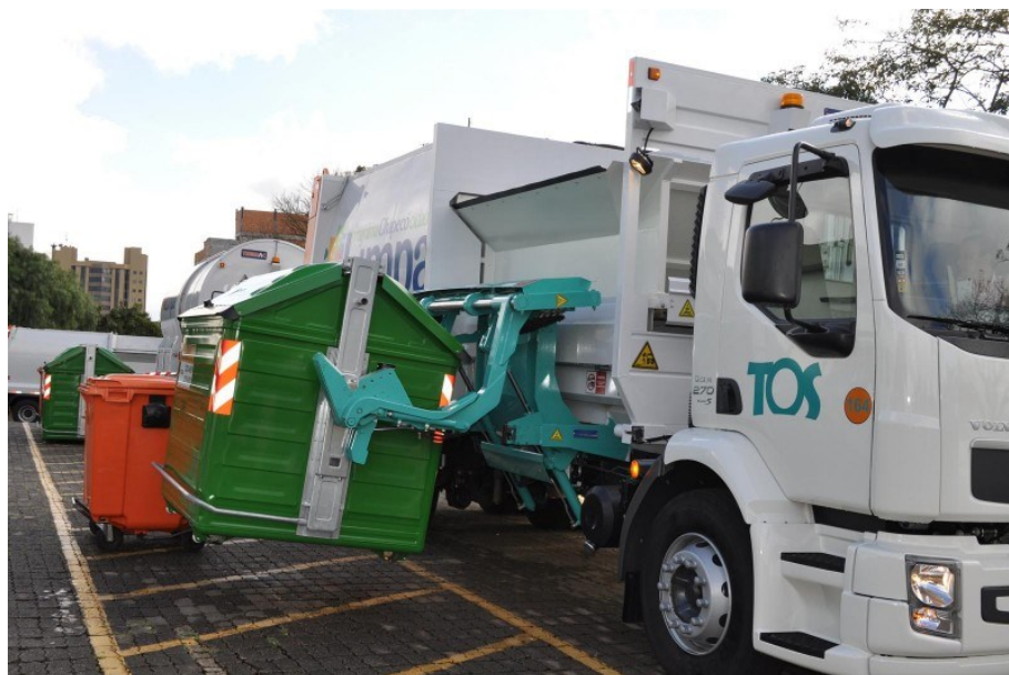
Foto 01 – Novo sistema automatizado de coleta de resíduos na cidade de Chapecó (SC) implantado desde 2013.
