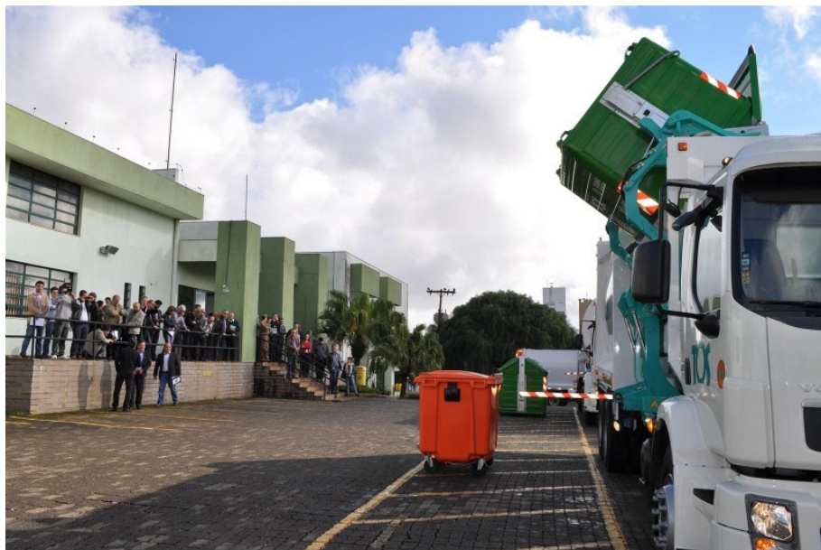
Foto 02 – Demonstração ao Poder Público do novo sistema automatizado de coleta de resíduos na cidade de Chapecó (SC) implantado desde 2013.
