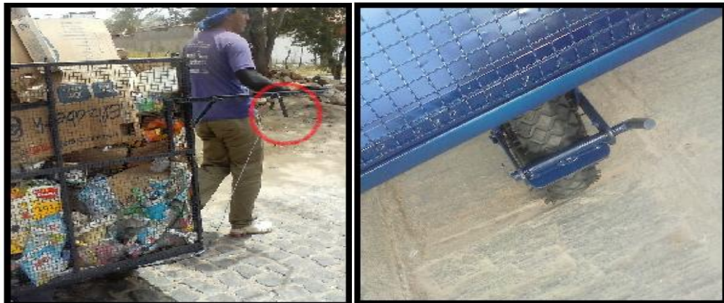
Figura 25. (A) Sistema de frenagem manual aplicado (B) Freio adaptado a roda frontal no T6. Campina Grande, PB. Janeiro de 2016.
