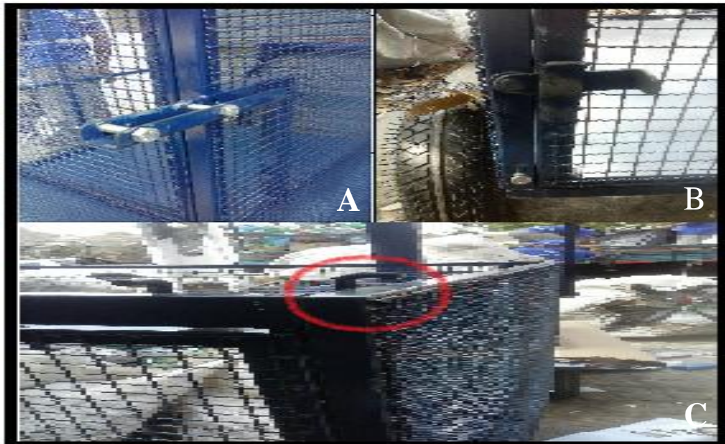
Figura 21. (A) Pegador parafusado para favorecer adaptação do T6 ao trabalhador (B) Trava para abertura da porta dianteira (C) Ganchos laterais para acomodação dos bags. Campina Grande, PB. Janeiro de 2016. Fotos: Bárbara Daniele
