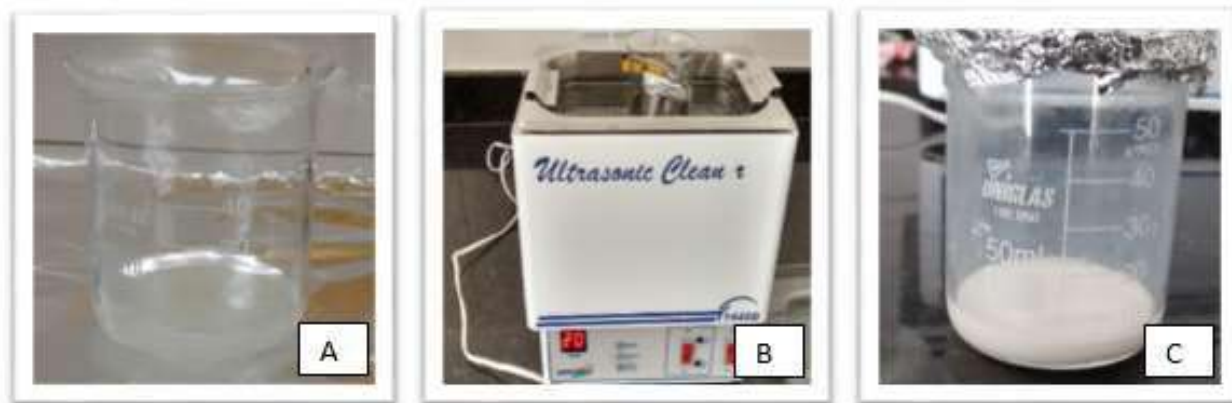
Figura 6: Fase inicial da dispersão; B) Processo de dispersão do SnO 2 na solução polimérica e C) Dispersão coloidal formada.
