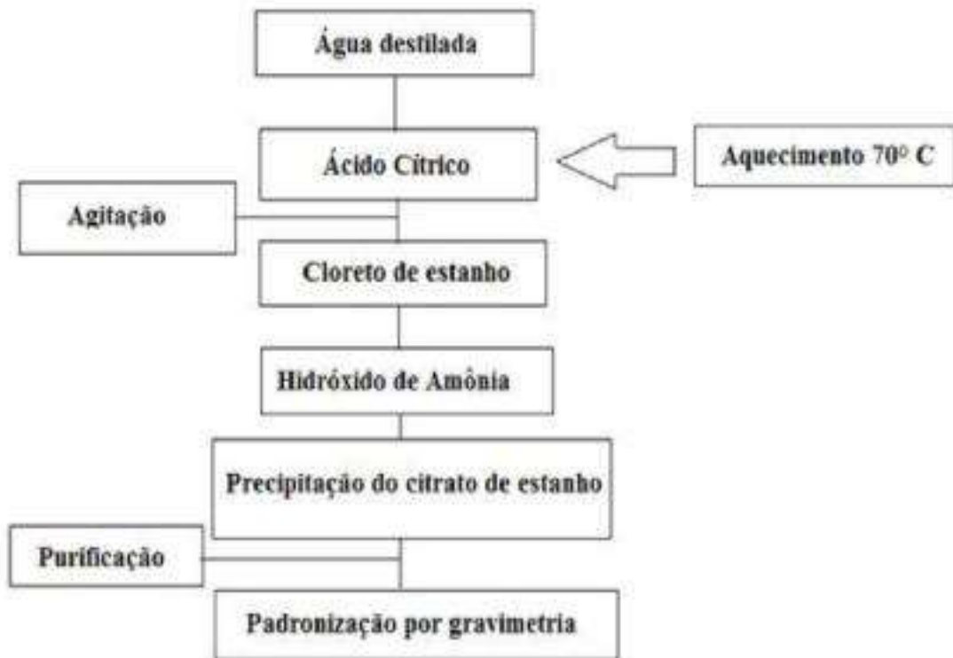
Figura 2: Procedimento experimental para preparação do Citrato de estanho.
