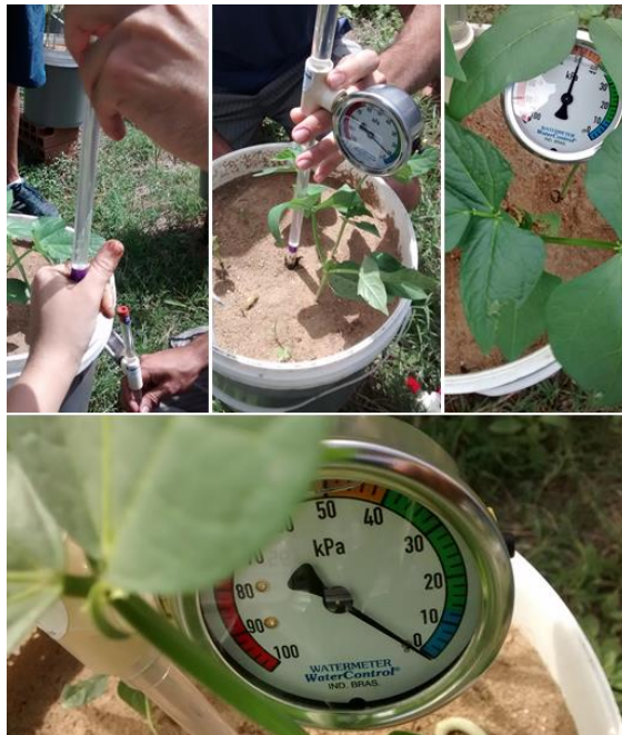
Figura 4. Instalação dos tensiômetros na área experimental. Campina Grande, 2016.
