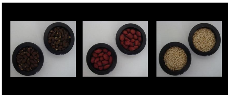
Figura 3 - Sementes intactas de algodão, amendoim e gergelim em célula de quartzo.
