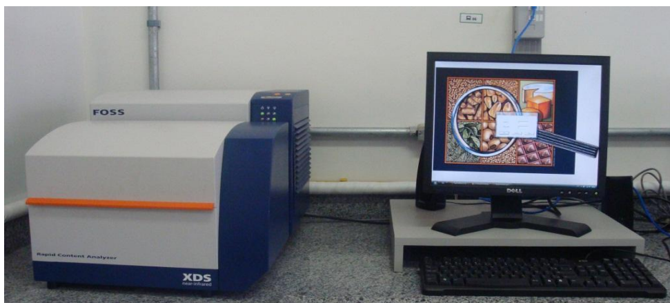
Figura 2 - Espectrômetro VIS – NIR modelo XDS Rapid Content Analyzer.
