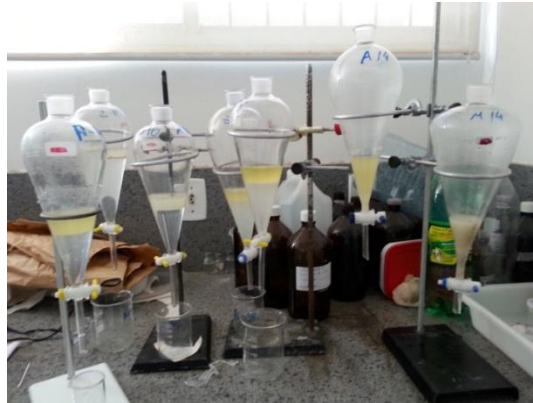
Figura 11: Processo de lavagem do biodiesel de mamona e amendoim.
