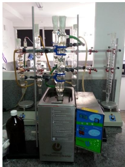
Figura 10: Sistema de refluxo conjugado a um balão de duas vias e acoplado a um sistema de aquecimento e tempo controlado, utilizando banho de ultrassom.
