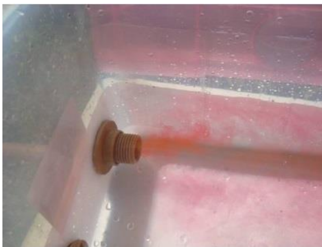
Figura 57 - Experiência para visualizar o efeito termossifão
