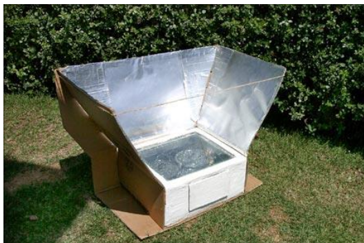
Figura 35 - Forno solar com abas laterais
