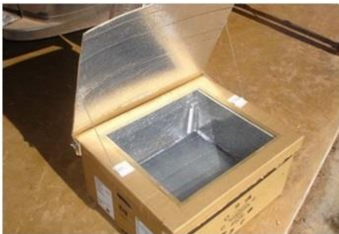
Figura 41 – Forno solar tipo caixa, produzido com materiais de baixo custo.
