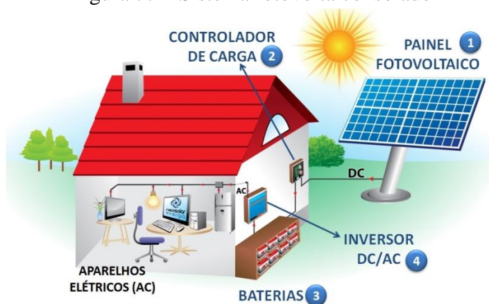
Figura 77 – Sistema fotovoltaico isolado
