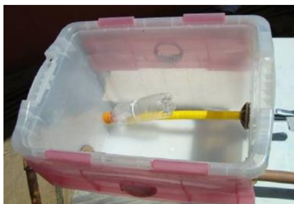
Figura 56 - Instalação do pescador e da torneira
