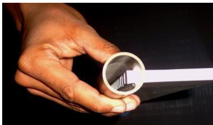
Figura 54 - Encaixe das placas nos tubos
