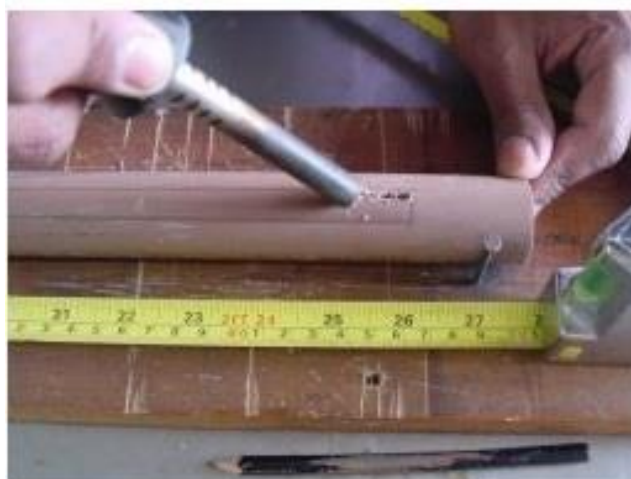
Figura 52 - Fazendo o corte que servirá de suporte para o coletor
