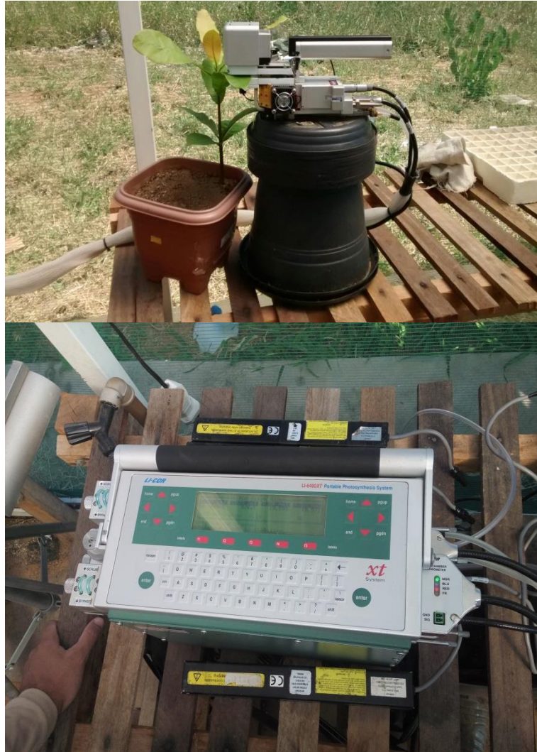
Figura 6 - Sistema Portátil de Fotossíntese (LI-6400XT, LI-COR, EUA). Serra Talhada-PE, 2016.
