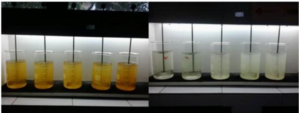
Após a adição de MgO, o sistema permaneceu sob agitação a 120 rpm por um período de 2h utilizando um equipamento jar-test; em seguida as amostras ficaram em repouso (Figuras 10 e 11) por 30 minutos e, terminada esta etapa, tanto o precipitado quanto o sobrenadante foram analisados.
