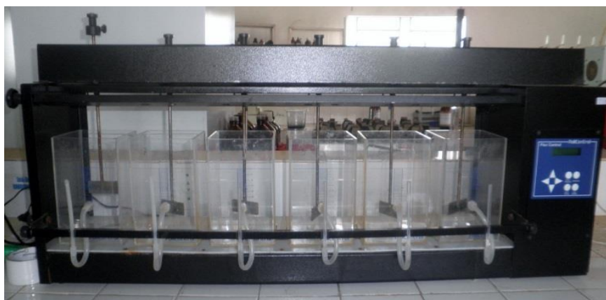
Figura 9: Sistema experimental: JarTest da marca Poli Control.
