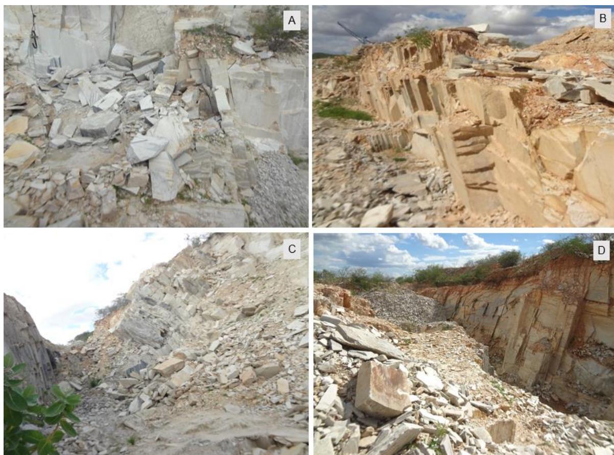
Figura 5.7 - Bancada apresentando matacões, taludes com inclinação negativa e rochas bastante fragmentadas
