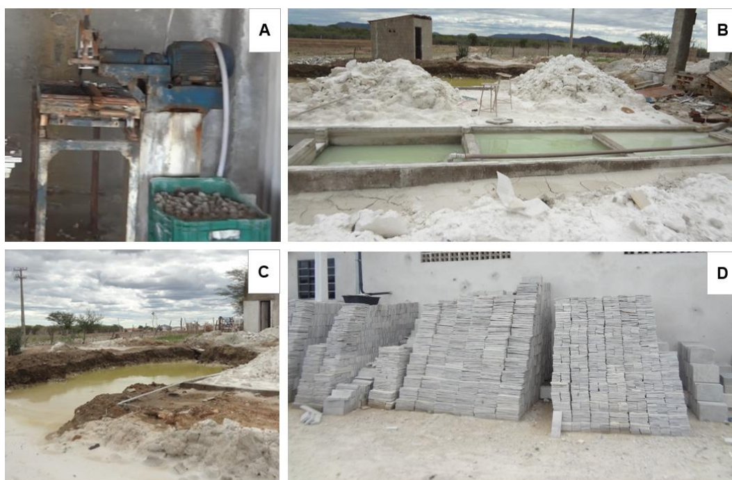
Figura 5.9 - Máquina, tanque de decantação e vala de infiltração utilizados no processo de beneficiamento da rocha
