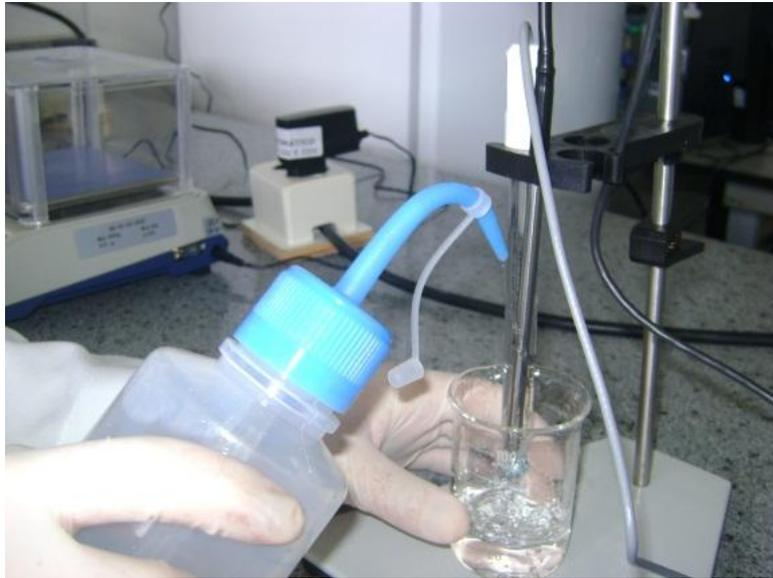
**Figura 2:** lavagem do eletrodo após medição de pH
