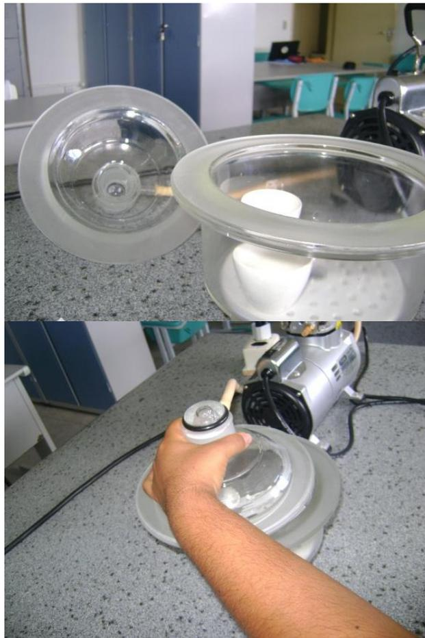
**Figura 4:** Dessecador utilizado no resfriamento das amostras
