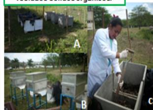
**Figura 1.** Composteiras confeccionadas em concreto (A), composteiras confeccionadas em aço inoxidável (B), instaladas na UEPB para o tratamento dos resíduos orgânicos entregues pelas famílias participantes do projeto e processo de reviramento realizado semanalmente para aeração do substrato (C), Campina Grande, 2014
