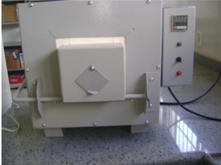
**Figura 3:** forno mufla utilizado para calcinação das amostras
