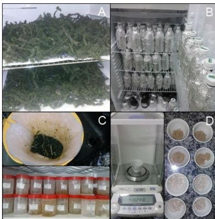
Fig. 4. Macrófitas secas na estufa a 40°C. B-Câmeras usadas no experimento C- Fracionamento da MOP da MOD usando um filtro comum- Balança analítica para pesagem da COP.
