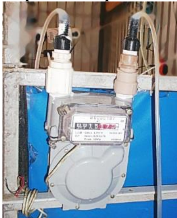
Figura 9: Equipamento para medir a quantidade de litros de ar
