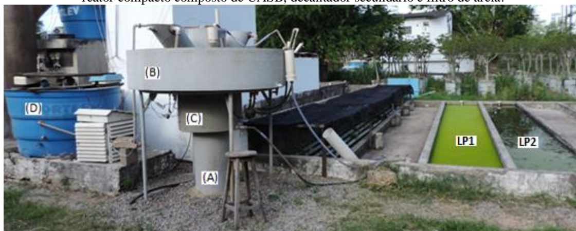
FIGURA 06 – Imagem real do sistema experimental 1. Duas lagoas de polimento como pós-tratamento de um reator compacto composto de UASB, decantador secundário e filtro de areia.
