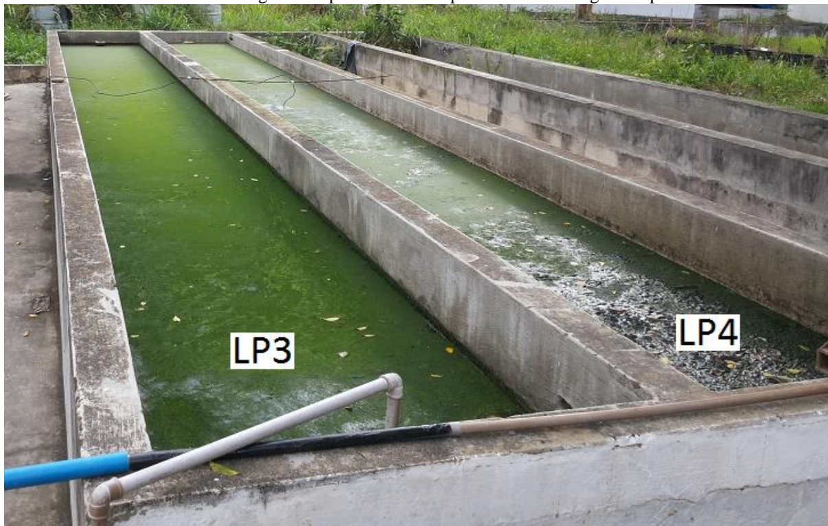
FIGURA 08 – Foto da segunda etapa do sistema experimental 2. As lagoas de polimento 3 e 4.
