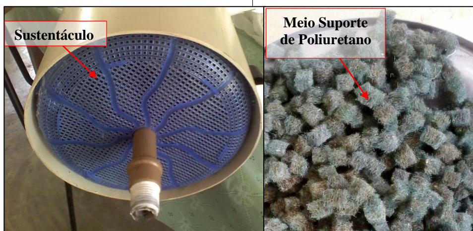
Figura 3: Sustentáculo e esponjas sintética cortadas utilizadas como meio suporte no RAH.
