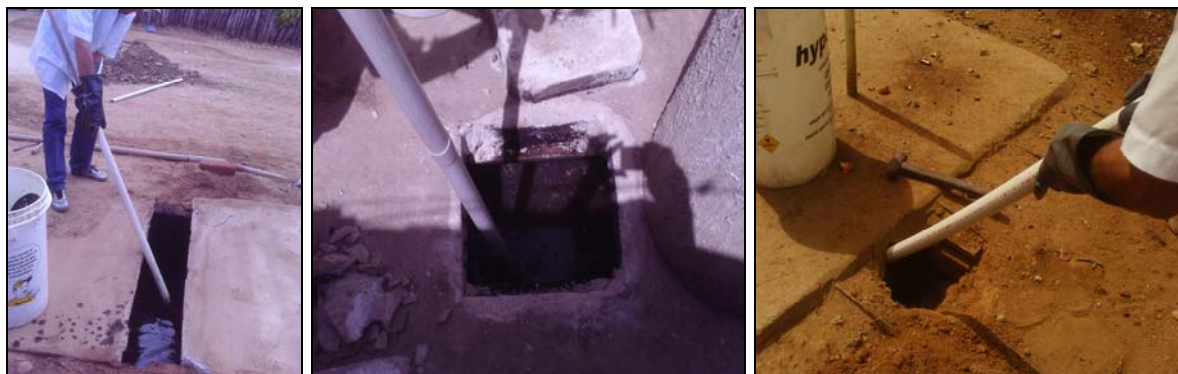
Figura 03 Foto de coleta de lodos em tanques sépticos unifamiliar no Distrito de Malhada da Roça, Município de São João do Cariri, semi-árido paraibano. 2008.
